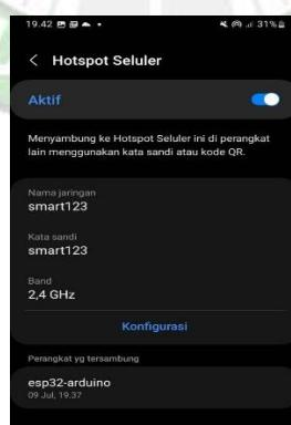
3. Langkah selanjutnya buka perangkat yang terhubung pada *smartphone*. Temukan alamat IP *adreess* dari perangkat yang terhubung pada *smartphone*
