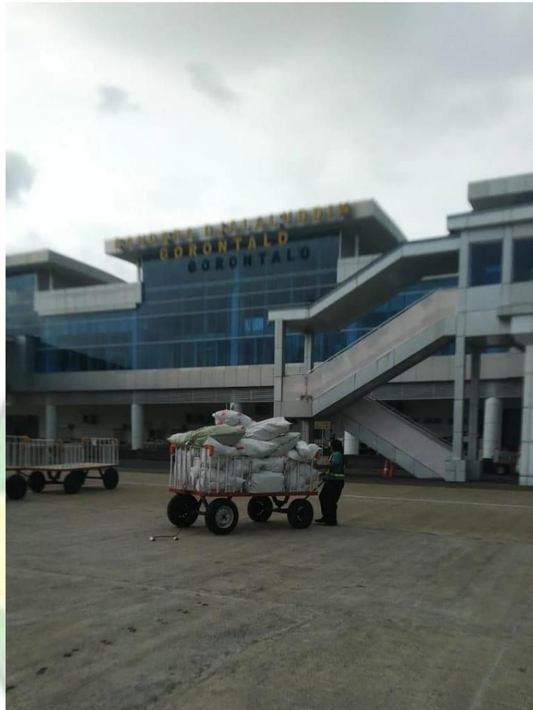
Gambar diatas merupakan bukti terjadinya sebuah kekurangan peralatan *Baggage Towing Tractor*. Hal tersebut terjadi ketika BTT sedang melayani salah satu pesawat di *Apron Bravo* sehingga pelayanan kargo di *Apron Alpha* tidak menggunakan BTT dan *baggage cart* didorong dan ditarik oleh petugas *ground handling*.
