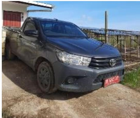
Mobil *Inspection* operasional yang bertugas pada unit Bangland dengan tipe merek mobil *Toyota Hilux Single Cabin* memiliki spesifikasi dengan Panjang 4.930 mm, Lebar 1.800 mm, Tinggi 1.685 mm, Jarak sumbu roda 2.755 mm, Jarak pijak depan 1.510 mm, Jarak pijak belakang 1.510 mm, Berat Maks 2.640 kg.
