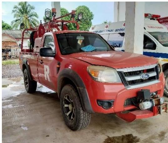
Mobil *Rescue Car* operasional yang bertugas pada unit PKP-PK dengan tipe merek mobil *Ford Ranger Single Cabin Base 2.2L MT* memiliki spesifikasi dengan Panjang 4.362 mm, Lebar 2.163 mm, Tinggi 1.806 mm, Jarak sumbu roda 3.200 mm, Jarak pijak depan 1.560 mm, Jarak pijak belakang 1.560 mm, Berat Maks 3.330 kg.
