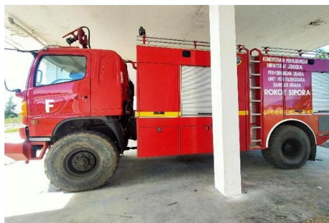
Mobil *Foam Tender Type VI* operasional yang bertugas pada unit PKP-PK dengan tipe merek mobil *FG 235 JU* memiliki spesifikasi dengan Kapasitas tangka air minimal 1.200 liter, tangka *foam* konsentrat minimum 12 persen dari kapasitas air tangka, kapasitas tepung kimia 250 kg. Berat Maks 15.100 kg.
