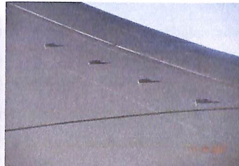
Gambar 2.1. Vortex Generator pada bagian belakang mobil dan sayap pesawat
