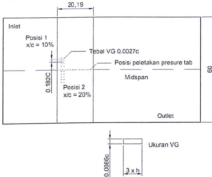
Gambar 3.4. Posisi peletakan VG pada penelitian eksperimen
