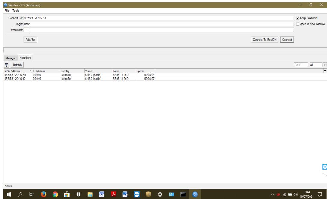
5. konfigurasi router untuk mendapatkan source internet dengan cara setting DHCP (Dynamic Host Configuration Protocol). Merupakan host dinamis yang secara otomatis memberikan nomer IP kepada router sebagai IP Public untuk jaringan Internet. Konfigurasi DHCP ini dilakukan dengan cara masuk submenu system > DHCP > klik New DHCP Client
