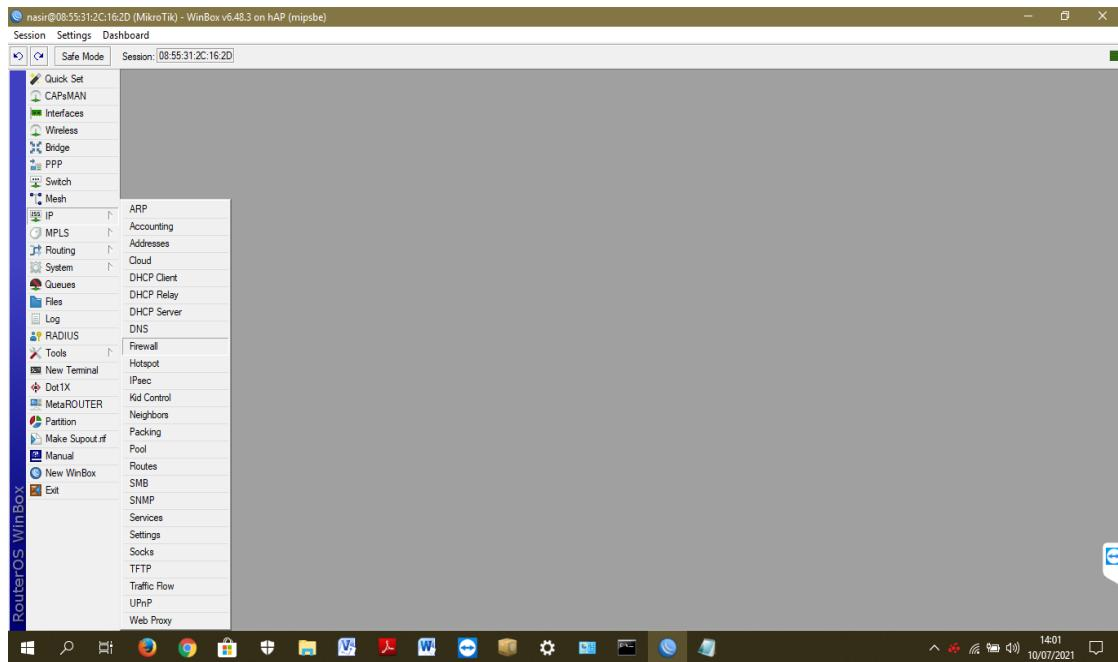
2. kemudian pilih input “1” karena perangkat yang melakukan sinkronisasi waktu terhubung pada port 1. Firewall melindungi perangkat (client) yang terhubung dengan router melalui port LAN. Apabila port 2 atau 3 terdapat perangkat (client) lain maka setting firewall juga dilakukan pada port tersebut.
