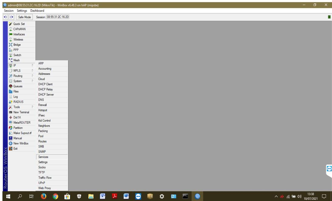
3. Memberhentikan service lain selain winbox ini bertujuan agar kinerja router optimal tanpa adanya kendala dari service lain yang dilakukan oleh router. Setelah itu router akan restart secara otomatis.
