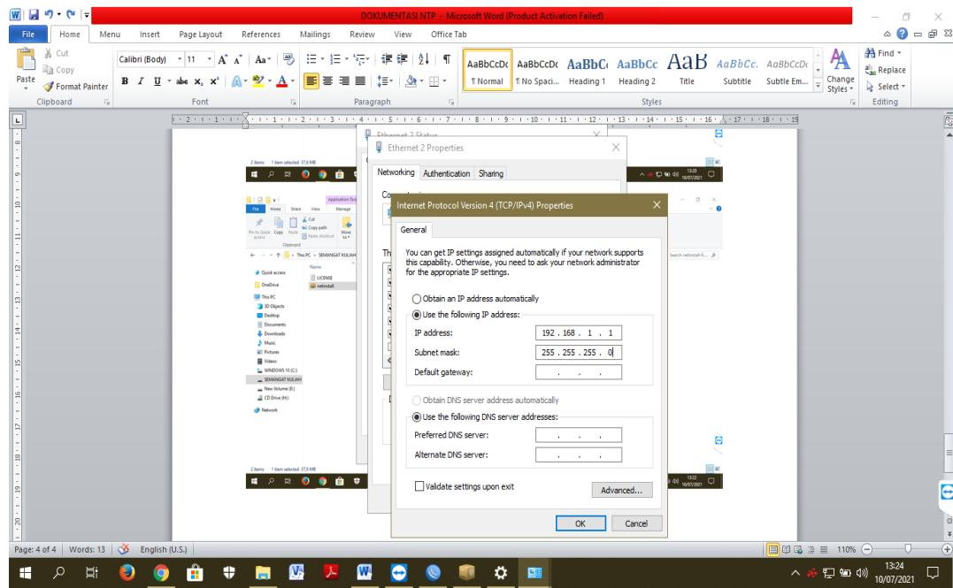
2. Cek IP PC yang telah dilakukan konfigurasi untuk memastikan kesesuaian IP yang telah dikonfigurasi. Pastikan bahwa setiap segmen dalam kelas IP yang sama.
