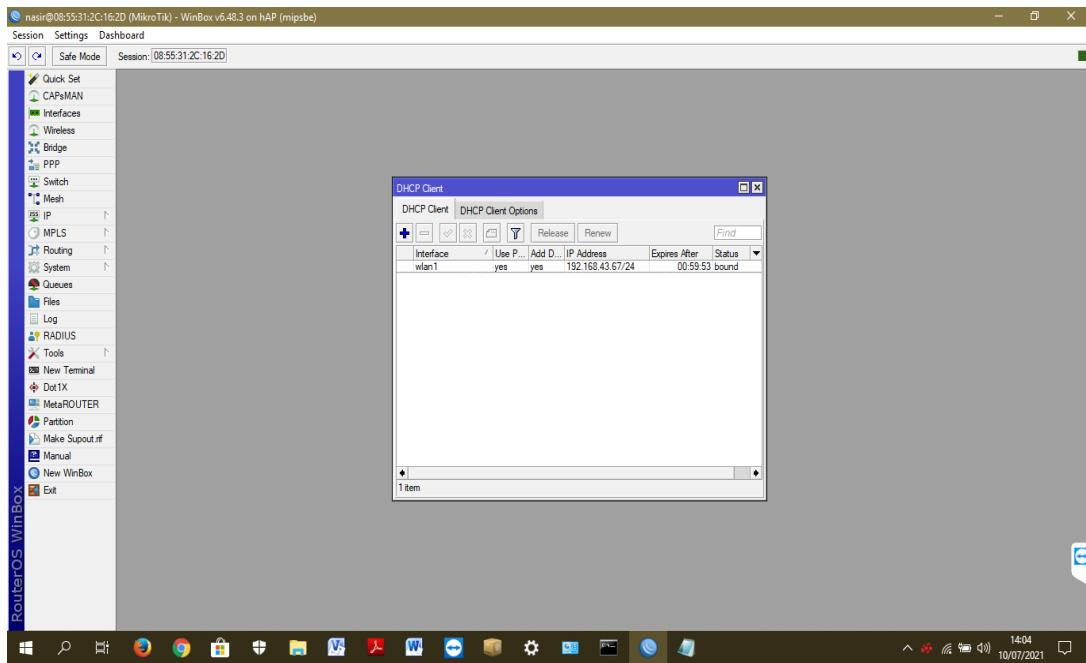
7. Setelah DHCP Client baru telah dibuat dan telah dipastikan ada. cek koneksi internet pada router dengan cara ping google.com di terminal winbox. Dengan cara pilih menu New Terminal > kemudian ketik “ping google.com”. apabila muncul nomer IP host, size transfer dan Time maka router telah terhubung internet.
