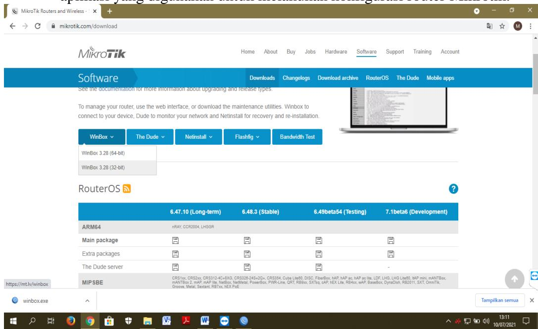
2. Download Netinstal pada mikrotik.com, dikarenakan Operating System Default tidak mampu menunjang kinerja Extra packagem aka dilakukan download Router OS (Router Operating System) yang baru untuk menunjang fitur-fitur tambahan lainnya pada Extra Package.
