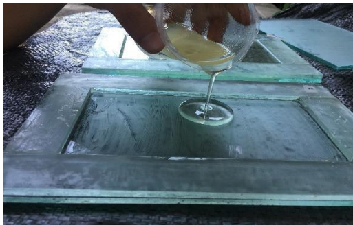
Penuangan Cairan Komposit kedalam cetakan
