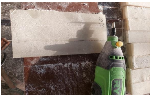
Proses Pembentukan Spesimen ASTM D638 - 03
