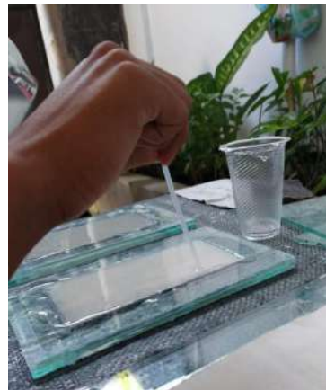
Meratakan matriks agar tidak terjadi bubble
