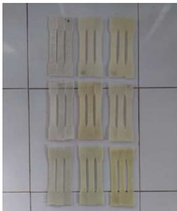
Komposit setelah dipotong sesuai standart ASTM D-638
