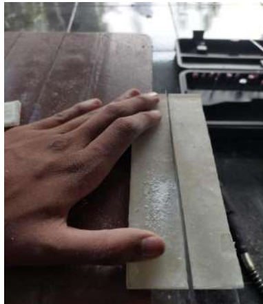
Memotong komposit dengan gergaji
