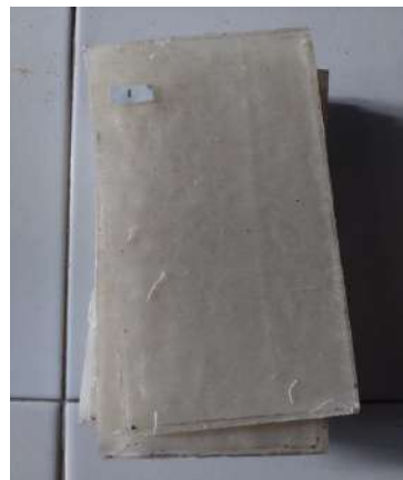
Komposit setelah proses pengeringan
