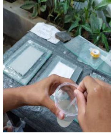
Proses pengadukan resin dan hardener
