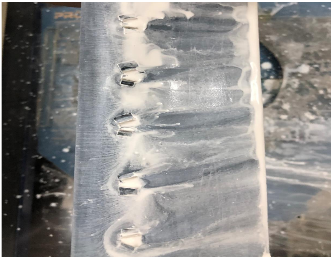
A.8 Airfoil dengan Rectangular VG pada sudut 4^\circ
