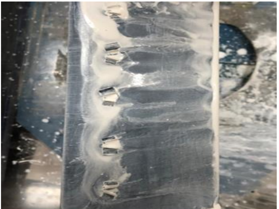
A.10 Airfoil dengan Rectangular VG pada sudut 10^\circ
