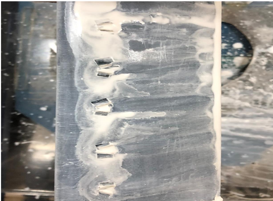
A.9 Airfoil dengan Rectangular VG pada sudut 8^\circ
