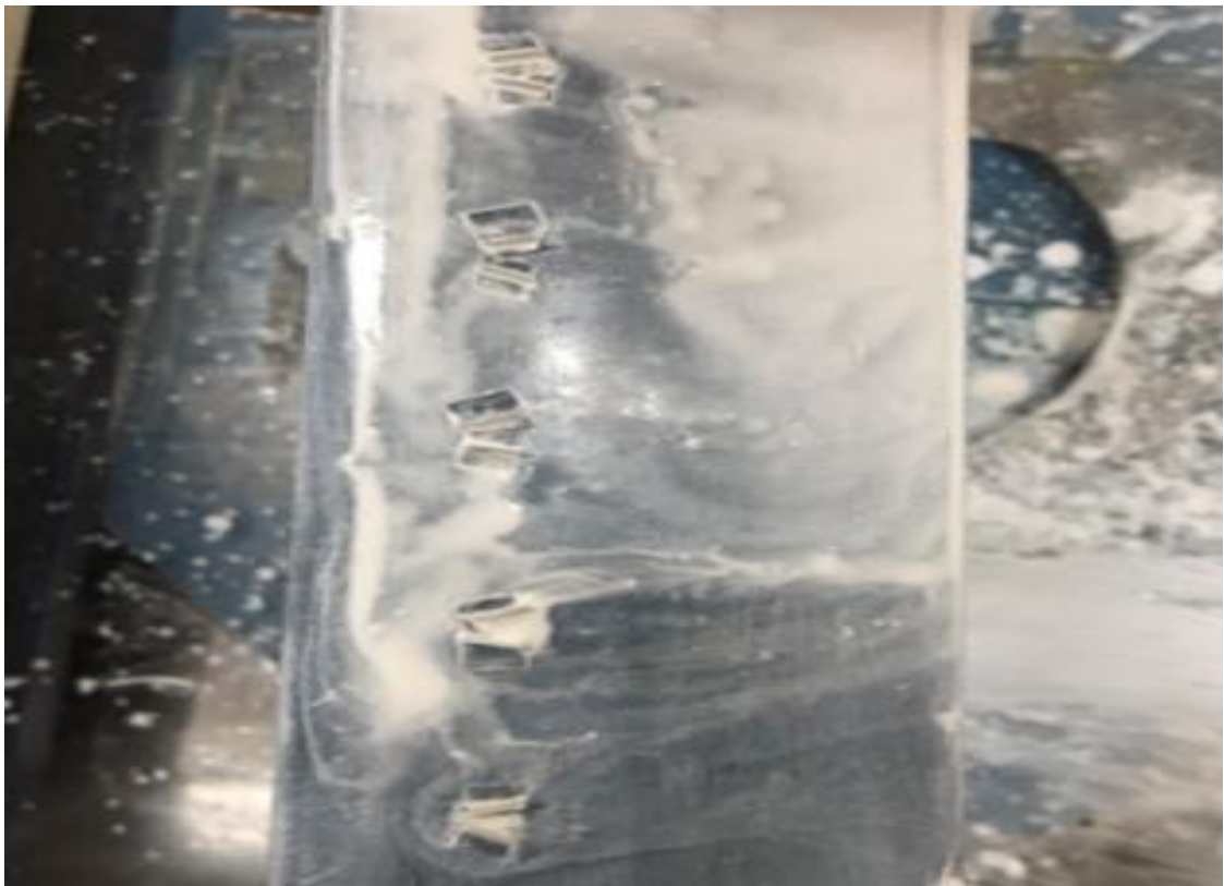
A.12 Airfoil dengan Rectangular VG pada sudut 20^\circ
