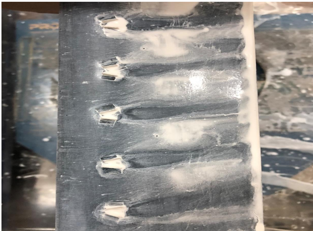
A.7 Airfoil dengan Rectangular VG pada sudut 0^\circ
