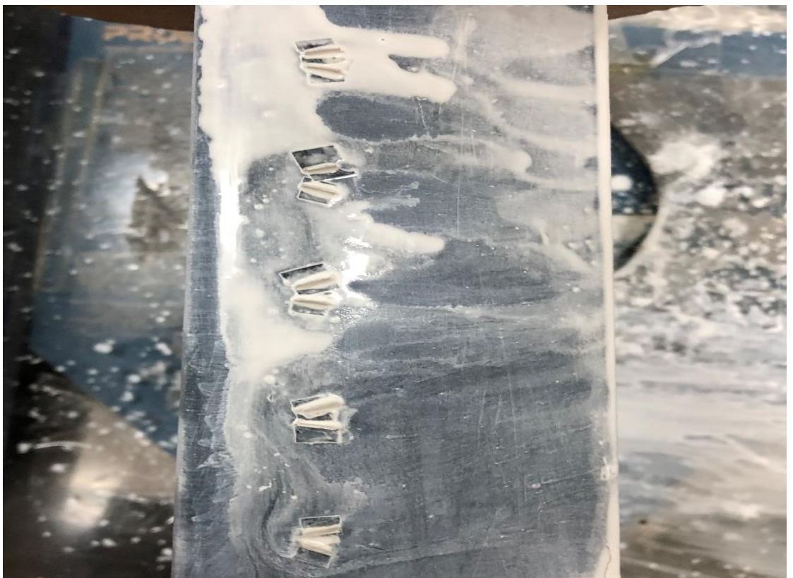
A.11 Airfoil dengan Rectangular VG pada sudut 16^\circ
