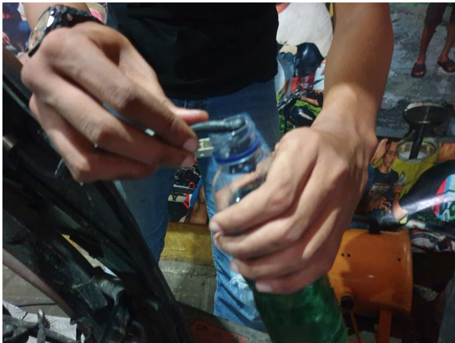
Penggantian fuel dari tiap-tiap takaran yang sudah ditentukan
