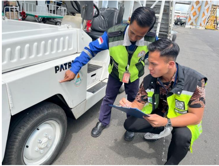
Gambar 4. 2 temuan ban/roda GSE yang sudah halus traksinya
