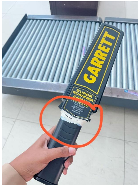
Gambar 4. 2 HHMD yang pegangannya hampir patah
