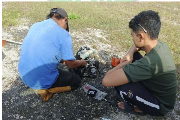
Gambar 4. 39 Perbaikan Selang Bahan Bakar Tersumbat pada Mesin Pemotong Rumput Baru (Sumber: Dokumentasi Pribadi, 2024)
