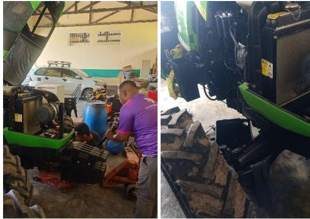
Gambar 4. 34 Penggantian Oli Hidrolik dengan Oli Pertamina Meditran S40 Sebanyak 8 Liter di Kedua Sisi Traktor (Sumber: Dokumentasi Pribadi, 2024)
