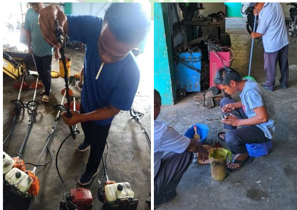
Gambar 4. 36 Pemberian Grease pada Batang Mesin dan Service Mesin Pemotong Rumput (Sumber: Dokumentasi Pribadi, 2024)
