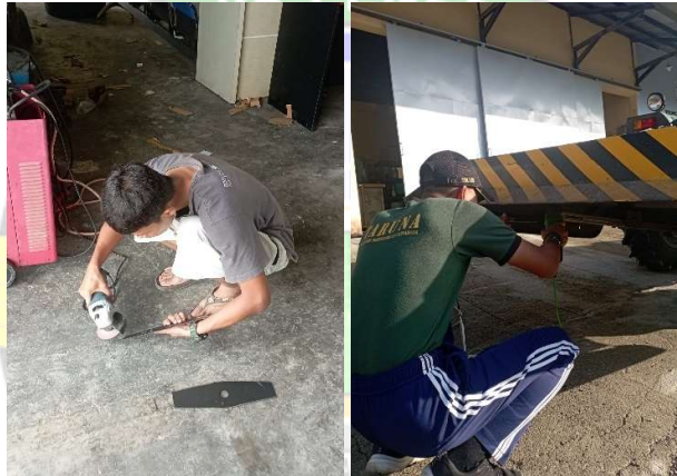
Gambar 4. 35 Penajaman Bilah Pisau pada Mesin Pemotong Rumput dan Traktor Menggunakan Gerinda (Sumber: Dokumentasi Pribadi, 2024)
