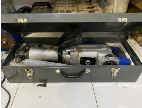
Gambar 4. 24 Jack Hammer (Sumber: Dokumentasi Penulis, 2024)
