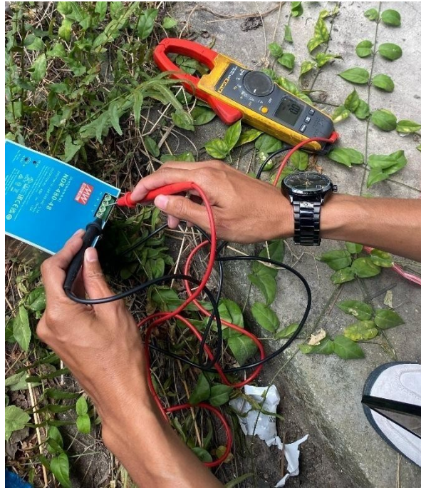
Gambar 3 . 23 Mnegukur Tegangan DC dari Power Suplay
