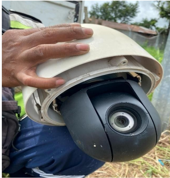
Gambar 3 . 23 Membesihkan Kotoran yang ada didalam CCTV
