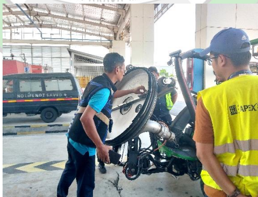
Gambar 4.18 Penggantian Sikat Waterblasting (Sumber : Dokumentasi Penulis)
