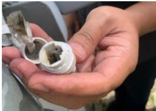
Gambar 3 . 19 Korosi pada RJ45 Sumber : Dokumentasi Penulis 2025
