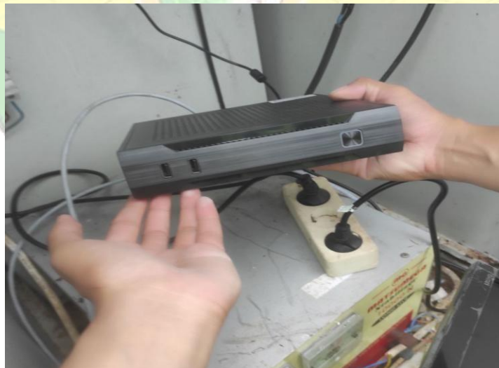
Gambar 3. 21 melakukan koneksi dari swicth cctv dengan mini PC Sumber : Dokumentasi penulis (2025)
