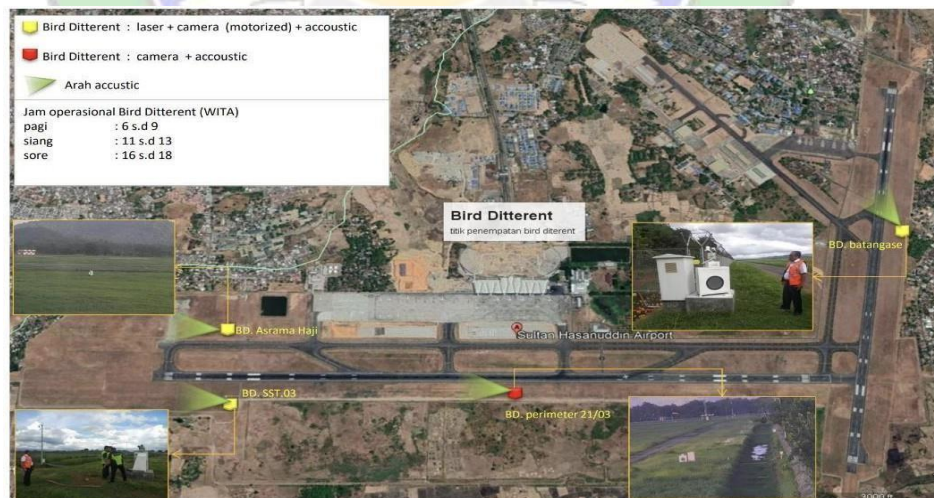
Gambar 3. 15 Map Bird deterrent Sumber : Dokumentasi Penulis (2025)
