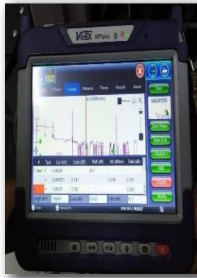
Gambar 3. 11 Optical Time Domain (Sumber : Dokumentasi Penulis)
