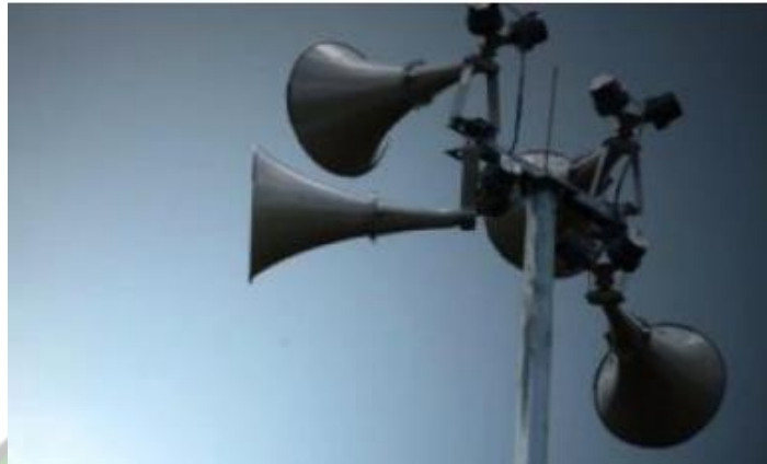
Gambar 4. 30 Alat pengusir burung metode akustik (Sumber: Dokumentasi Penulis,Tahun 2024)
