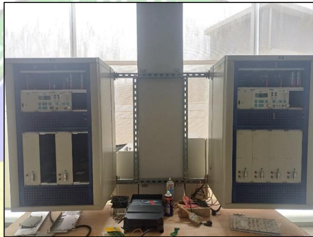
Gambar 3. 13 ILS NORMARC Sumber: Dokumentasi penulis
