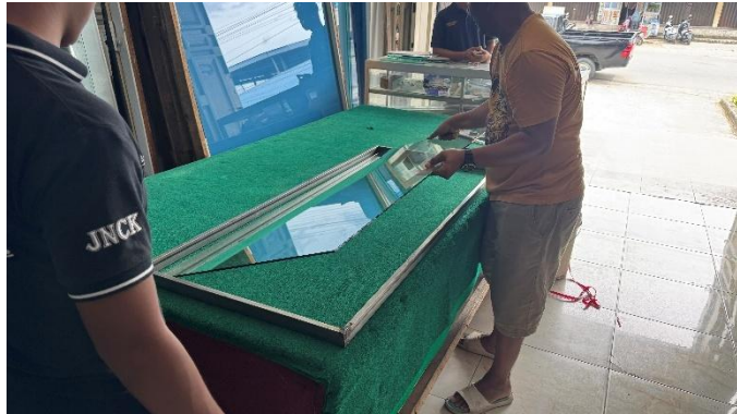
Gambar 4. 155 Pemasangan Kaca pada Rangka Jendela
