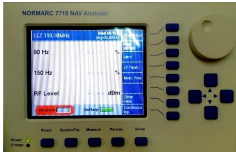
Gambar 3. 22 Display NAV Analyzer PIR Merk Normarc Sumber : Dokumentasi Penulis
