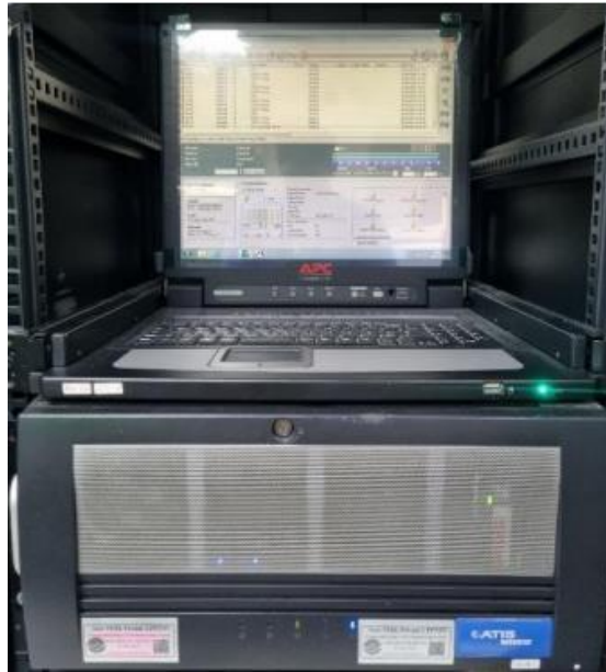
Gambar 3. 4 Server Recorder Merk ATIS UHER Sumber : Dokumentasi Penulis
