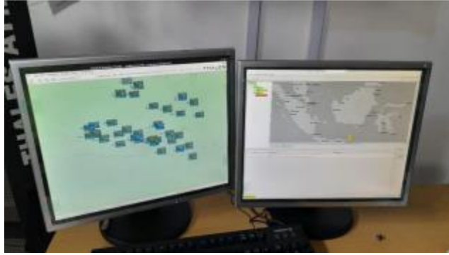
Gambar 3. 16 Display ADSB Merk THALES Sumber: Dokumentasi Penulis
