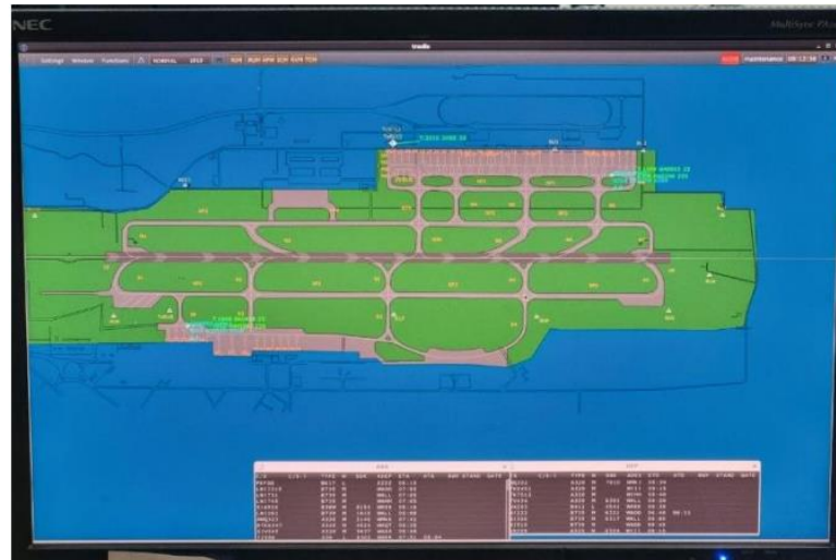
Gambar 3. 20 Display ASMGCS Sumber: Dokumentasi Penulis
