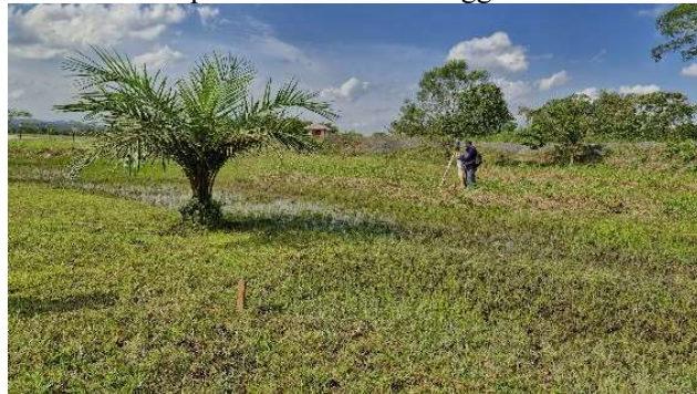
Gambar 4. 33 pencarian elevasi menggunakan theodolit
