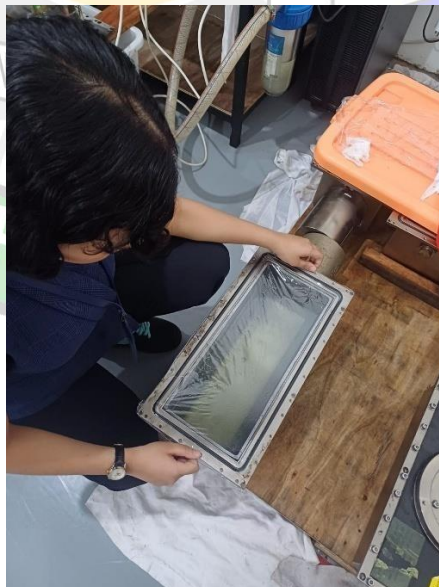
GAMBAR 3. 33 Proses Mengganti oli baru pada Generator
