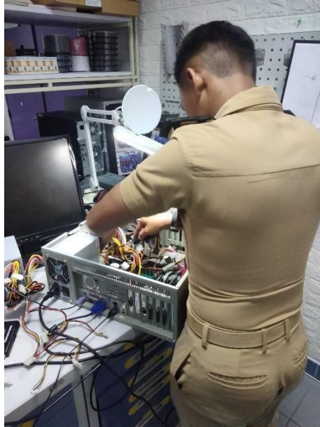
Gambar 4 . 5 Proses Pergantian power supply di lab automasi Sumber : Dokumentasi Penulis (2024)
