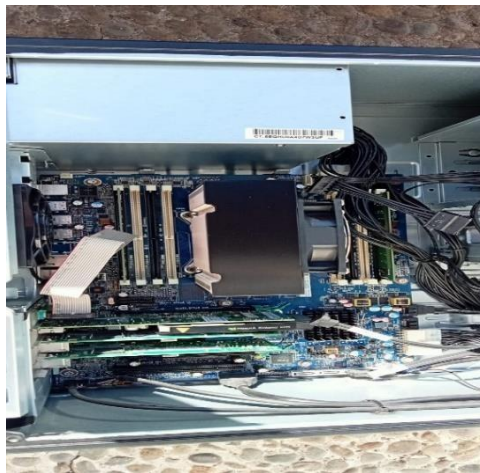
Gambar 4 . 5 Proses Pergantian power supply di lab automasi Sumber : Dokumentasi Penulis (2024)
