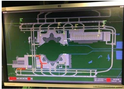
Gambar3. 40 RCMS A-SMGCS Di Processing Room
