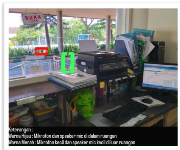
Gambar 4.10 Sketsa penempatan mikrofon dan speaker mic di customer service citilink Malang
