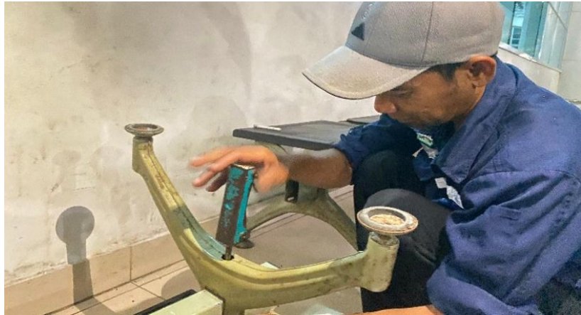
Gambar 4. 33 Pemasangan Baut Pada Kaki Kursi (Sumber: Dokumentasi Penulis)
