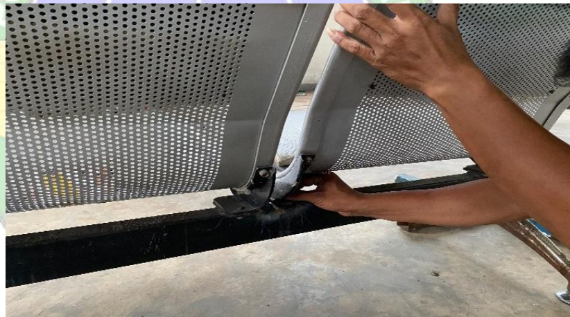
Gambar 4. 34 Proses Pengecekan Tiap Sudut Kursi (Sumber: Dokumentasi Penulis)
