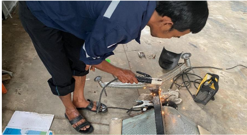
Gambar 4. 35 Proses Pengelasan Kursi (Sumber: Dokumentasi Penulis)
