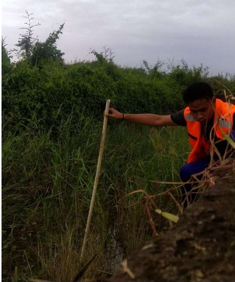
Gambar 4. 39 pengecekan kedalaman sedimentasi tanah
