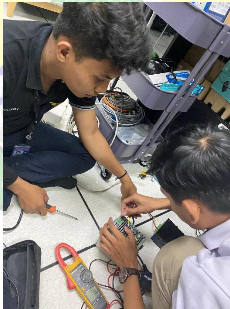
Gambar Lampiran 9 Melakukan Pengecekan Tegangan Output Power Supply CCTV
