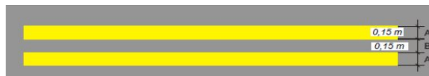
Gambar 3. 7 Apron Edge Marking
