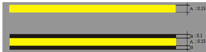
Gambar 3. 2 Garis Lead-In dan Lead-Out untuk Pesawat Udara (Sumber : PR No. 21 Tahun 2023 Manual of Standard CASR 139 )
