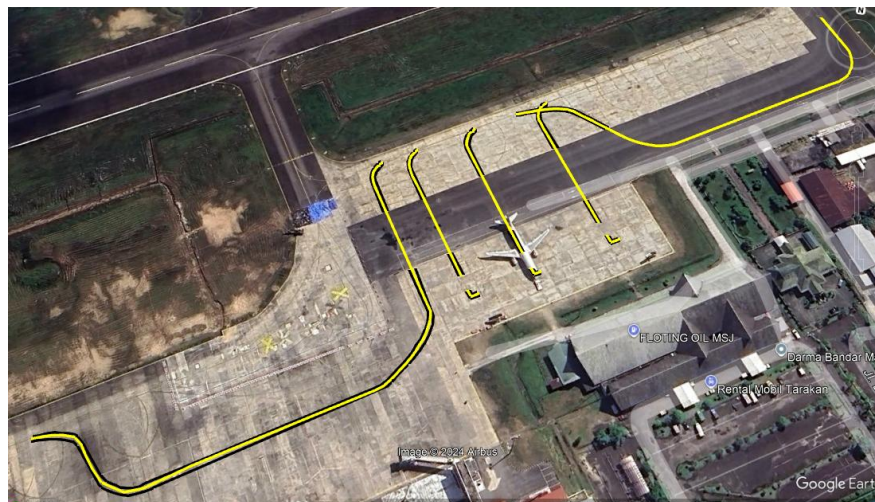
Gambar 4. 13 Layout pengecatan marka lead-in dan lead-out temporary (Sumber : Olahan Penulis)
