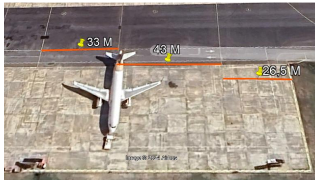
Gambar 4. 17 Menentukan area pengecatan dan jarak antar marka (Sumber : Google earth)
