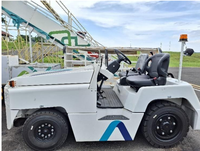
Gambar 4. 7 Tidak adanya Name Plate pada Aircraft Towing Tractor
