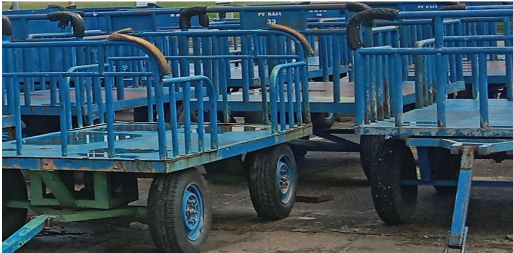
Gambar 4. 4 Adanya Baggage Cart non motorizes yang berkarat
