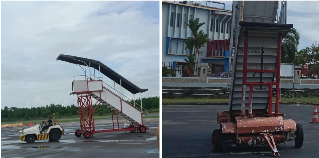
Gambar 4. 6 Warna cat pada Pax Stairs yang sudah pudar
