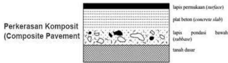
Gambar 3. 3 Lapisan Perkerasan Komposit (Sumber : www.google.com 2024)
