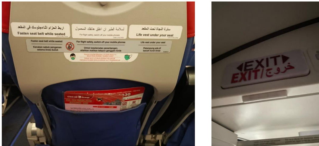
Gambar 4.32 Setelah instalasi placards
