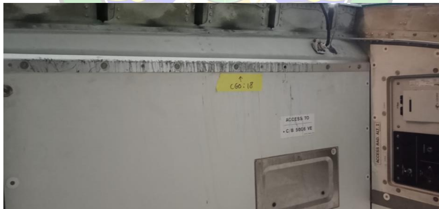
Gambar 4.49 Scratch pada aft cargo ceiling metal lining strip
