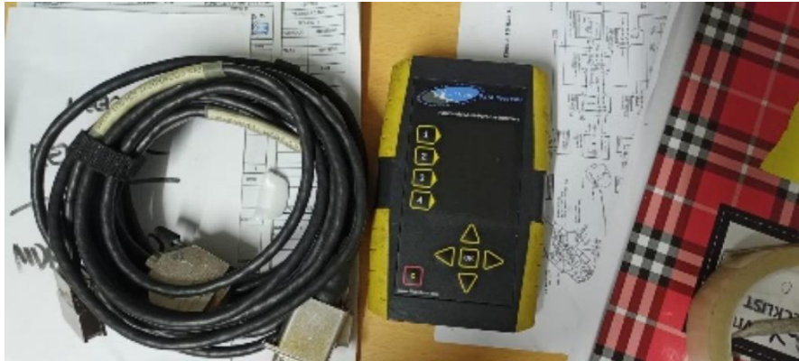
Gambar 4.26 HHMPI CVR/FDR readout
