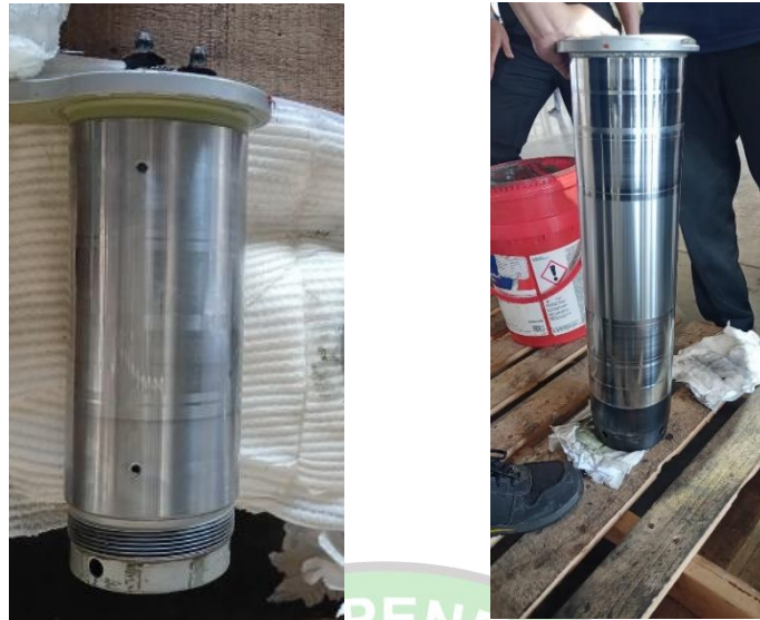
Gambar 4.24 Inspection komponen pivot pin
