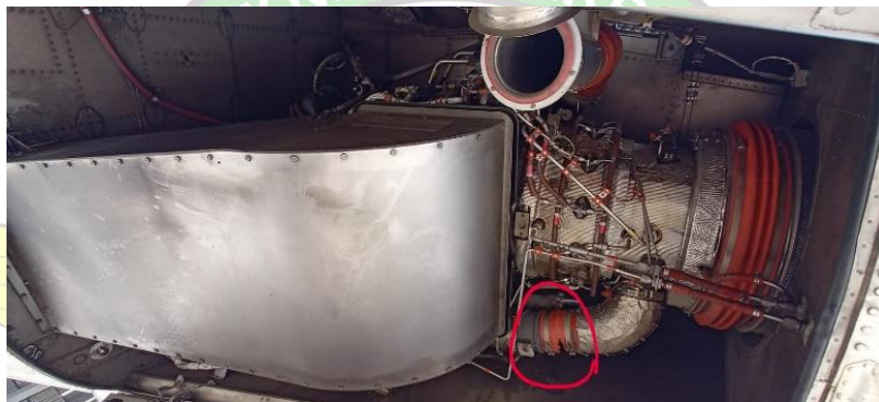
Gambar 4.9 Penemuan kerusakan pada komponen APU
