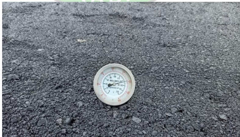
Gambar 4.15 Pengukuran suhu hampar (sumber : olahan penulis, 2023)
