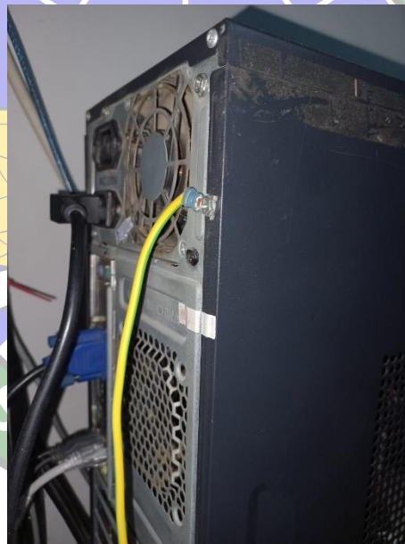
Gambar 3.42 gounding pada PC Komputer
