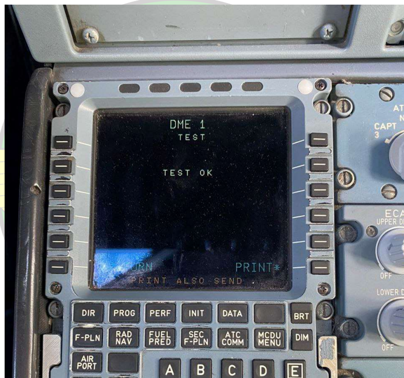
Gambar 4. 17 Hasil BITE TEST DME 1 pada MCDU
