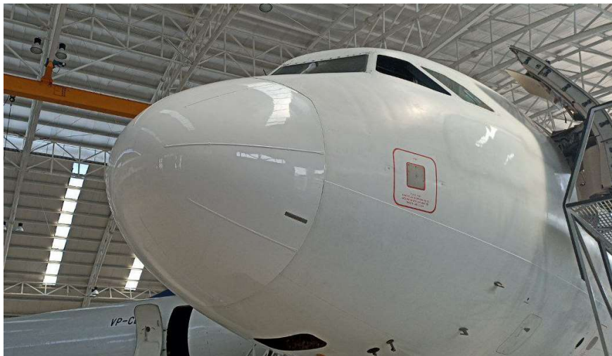
Gambar 3. 6 Nose Airbus A320 tempat Weather Radar berada
