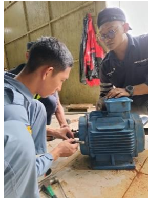
Gambar 4. 13 Proses Pembongkaran Motor 3 Phase Sumber : Dokumentasi Pribadi
