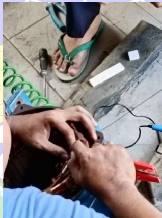
Gambar 4. 14 Proses Penyambungan Kumparan Motor Sumber : Dokumentasi Pribadi
