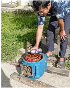
Gambar 4. 15 Proses Penyemprotan Cairan Isolator Pada Motor Sumber : Dokumentasi Pribadi
