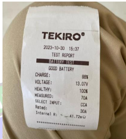
Gambar 3. 31 Hasil Bacaan Battery Baru GOOD-BATTERY Sumber: Dokumentasi Penulis, 22 November 2023
