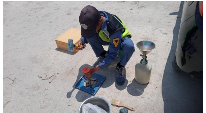
Pengujian sandcone pada subgrade apron
