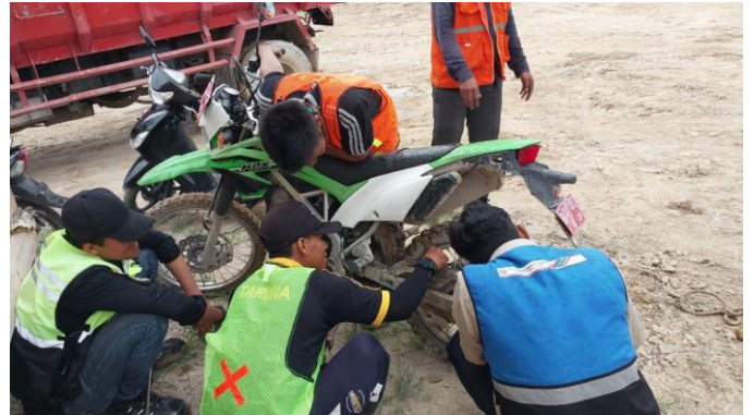
Memperbaiki rantai motor dinas
