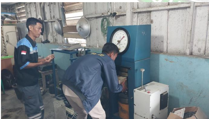
Melakukan uji kuat tekan beton di laboratorium Semurup
