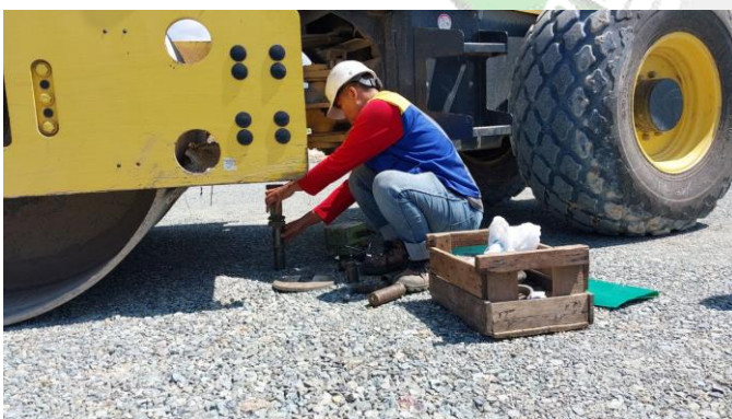
Pengujian CBR pada subbase apron
