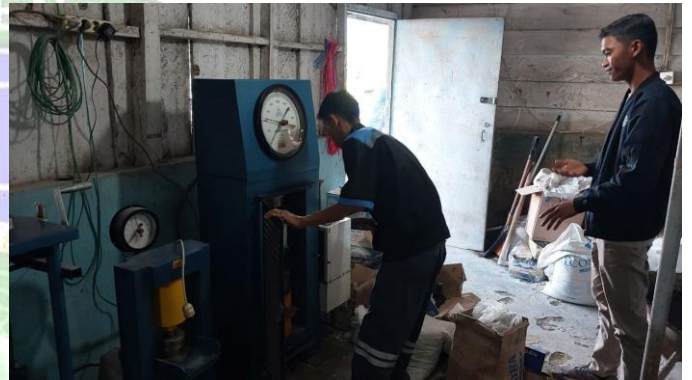
Melakukan uji kuat tekan beton di laboratorium Semurup
