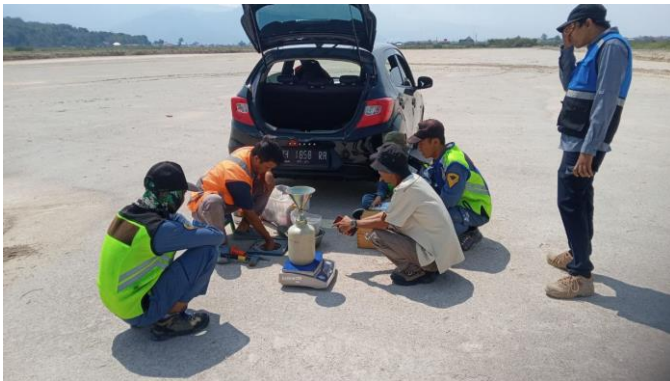
Pengujian sandcone pada subgrade apron
