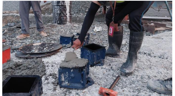
Membuat sampel kubus untuk uji kuat tekan beton
