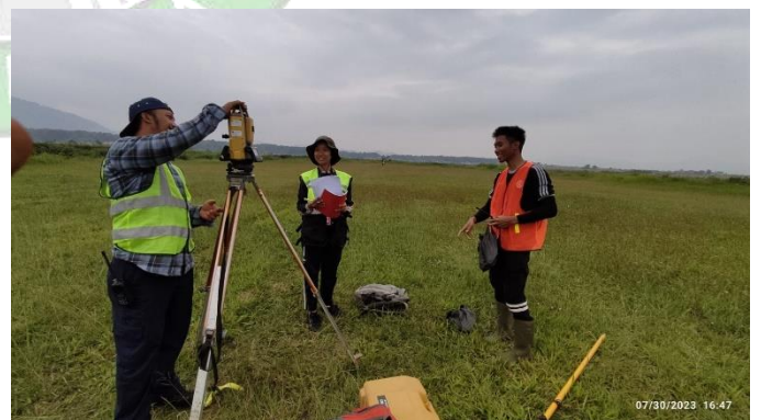
Mengukur RESA 12 dengan Total Station
