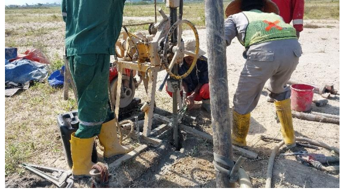
Mengambil sampel tanah dengan cara boring
