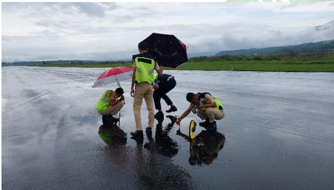
Mengukur genangan air pada Landasan
