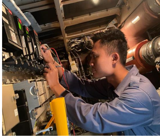
Gambar 4.7 Pengukuran VHF 1 Transciever
