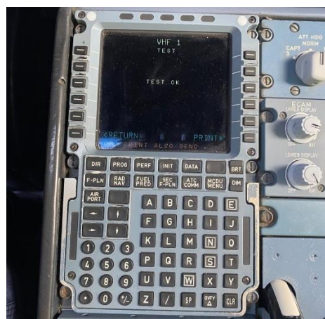
Gambar 4.13 Functional Test VHF 1 Transciever pada MCDU
