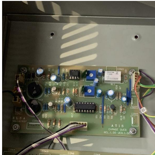
Gambar 3. 10 Block Audio Voice Change Over Sumber : Dokumentasi Penulis(2023)
