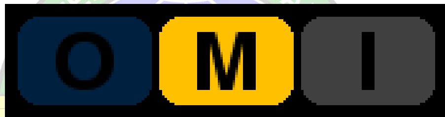
Gambar 2. 22 Tampilan Visual Marker Beacon Di Pesawat Sumber : Modul Pembelajaran Politeknik Penerbangan Surabaya (2023)
