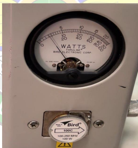
Gambar 3. 54 Power Output setelah dipasang cavity filter (8,2 watt) Sumber: Dokumentasi Penulis, 2023
