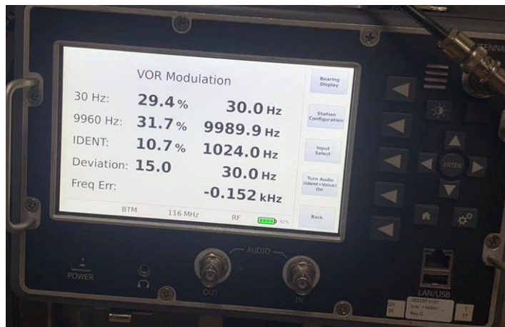
Gambar 3. 38 Nilai Ground Check DVOR Pada PIR Sumber: Dokumentasi Penulis, 2023
