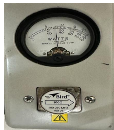
Gambar 3. 57 Foward Power yang terukur di Radio Becker setelah memakai cavity filter (32 watt)
