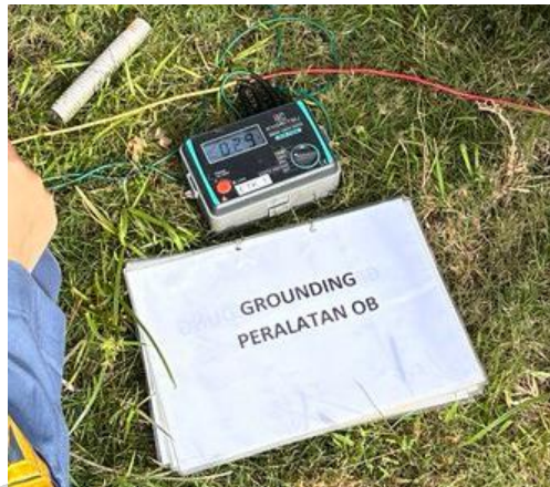
Gambar 3. 39 Nilai Grounding Pada Earth Tester Sumber: Dokumentasi Penulis, 2023
