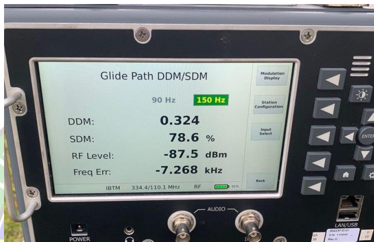
Gambar 3. 36 Contoh Nilai DDM dan SDM Ground Check GP Sumber: Dokumentasi Penulis, 2023
