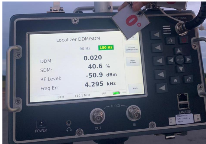
Gambar 3. 35 Contoh Nilai DDM dan SDM Pada 0° Localizer Sumber: Dokumentasi Penulis, 2023
