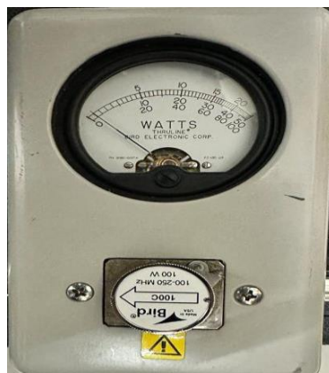
Gambar 3. 56 Reverse Power yang terukur di Radio Becker setelah memakai cavity filter (2 watt)
