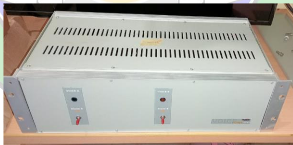
Gambar 3.30 Modul Changeover Voice ATIS Sumber : Dokumentasi Penulis, 2023
