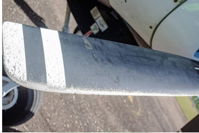
Gambar 4.17 Baling-baling pesawat yang terkena kerikil (Sumber: Dokumentasi Pribadi, 2023)
