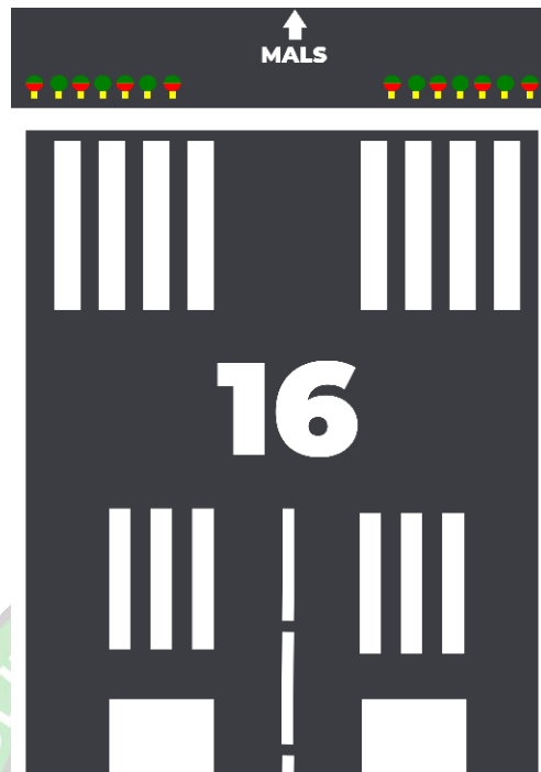
Gambar 4.7 Tampilan Elevated Threshold Light Pada Runway 16
