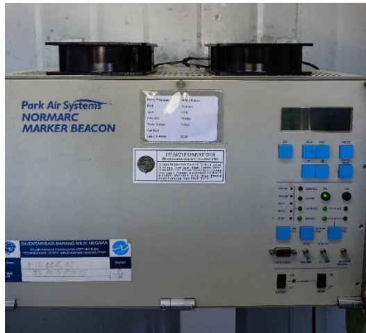
Gambar 3. 17 Peralatan Middle Marker Sumber : Dokumentasi Penulis (2023)
